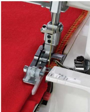
Blindsäume erfordern etwas Praxis für gute Ergebnisse. Sie können diese Säume mit der Overlock nähen. Damit Ihre Säume optimal werden, verfügt der Fuß über einen verstellbaren Anschlag für eine perfekte Kantenführung.
