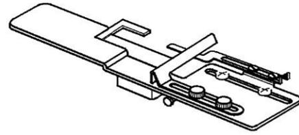
Die Saumführung faltet eine gleichmäßige Breite des Stoffes um und erleichtert so das Nähen von Säumen, Ärmelkanten und ähnlichen Abschlüssen. Nähen Sie runde Formen, wie z. B. einen Rock dann drücken Sie die Freigabetaste, kurz vor dem Ende der Naht, um die Führung freizugeben. Jetzt können Sie die Naht sauber beenden. Eine durchdachte Lösung.
