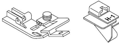
Diese effiziente und clevere Führung faltet Kanten perfekte 6 mm (1/4") um. Gleichzeitig mit dem Säumen wird die darunter liegende Spitze oder Borte angenäht. Verwenden Sie den Coversaumfuß.
