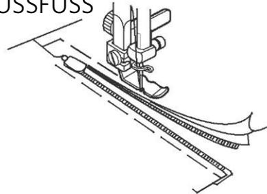
Dieser Fuß kann rechts und links am Halter befestigt werden, um die entsprechende Reißverschlußseite anzunähen. Auch zum Annähen von Paspeln geeignet.
