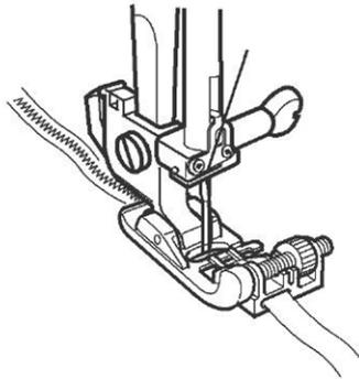
Ebenso einfach wie das Aufnähen von Perlenbändern mit dem Perlenfuß ist mit diesem Fuß das Aufnähen von Pailletten- und Satinbändern. Die verstellbare Führung führt die Bänder in Richtung der Naht. Nutzen Sie diesen Fuß, um ein schmales Band und mit breitem Leiterstich für Durchzüge. Ideal für Gardinen und überall dort, wo Sie manuell fälteln müssen.
