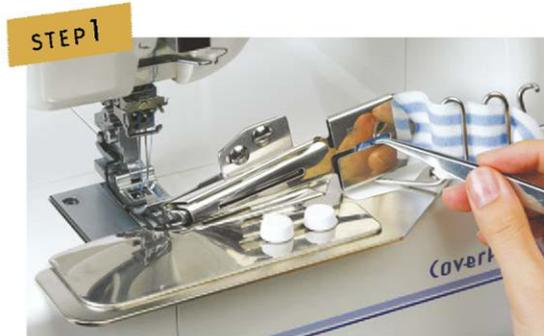
Führen Sie den Stoff, der als Einfassband geformt werden soll, wie gezeigt in die Führung ein.
