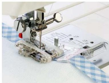
Die verstellbare Führung erlaubt das Annähen von vorgefalteten Schrägbändern bis 20 mm Breite.
