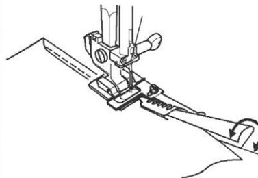
Mit dem Bandenfasser lassen sich einfach vorgefaltete Schrägbänder falten und annähen. Die trichterförmige Führung formt das Band und legt es direkt um die Stoffkante. Mit einem Zier-, Zickzack- oder Geradstich annähen und schon ist die Kante versäubert. Schrägbänder von 10 bis 14 mm Breite können verarbeitet werden.
