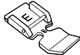
Beim Reißverschluss Einnähen mit diesem Fuß wird die Nadel nach links oder rechts versetzt.
