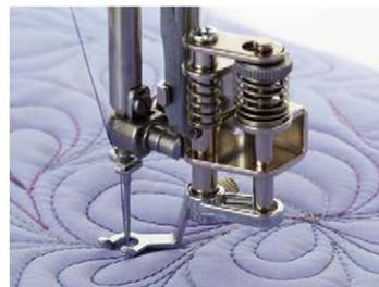
Ein Fuß für den normalen Einsatz, jedoch mit einer Öffnung für bessere Sicht auf den Nadelbereich und das perfekte Führen beim Freemotion Quilting.
