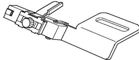
Damit wird das Annähen von Gummibändern zum reinen Nähvergnügen. Besonders Bündchen und Ärmel, sowie Dessous lassen sich perfekt verarbeiten. Für unterschiedliche Bandbreiten und Positionierungen erhalten Sie diese Führung in zwei Ausführungen. Einfach Band einspannen und mit der Schraube die Dehnung bestimmen.
