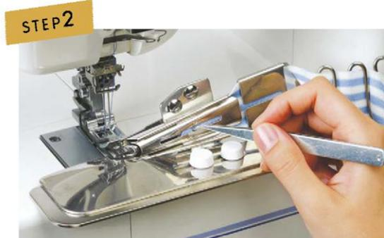
Schieben Sie den Stoff mit der Spitze der einer Pinzette durch die trichterförmige Führung.
