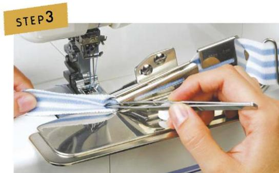
Ziehen Sie das Bandende heraus und benutzen Sie dabei die Pinzettenspitze, um das Band zwischen die obere und untere Führung am Ende der Röhre zu schieben, und führen dann das Band dann unter den Nähfuß. Legen Sie die Stoffkante in die Röhre ein und nähen Sie das Band an, das gefaltet wird und gleichzeitig die Kante einfasst.
