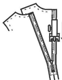
Mit diesem Fuß nähen Sie professionelle, nahtverdeckte Reißverschlüsse problemlos ein. Die Rillen der Unterseite führen die Zahnung exakt zur Naht.
