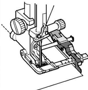
Dieser Fuß hat eine praktische Führungsschiene in mm und Inch. Besonders hilfreich für akkurate Nahtbreiten, z.B. 12 oder 16 mm breite Säume oder die Einschläge bei Hosen und Dessous!
