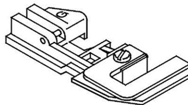
Mit diesem Kräuselfuß ist es sehr einfach modische Akzente zu setzen. Der untere Stoff wird gekräuselt, während er mit dem oberen Stoff vernäht und gleichzeitig versäubert wird.
