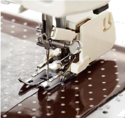
Der Obertransportfuß, der manchmal auch als Wanderfuß (Walking Foot) bezeichnet wird, ist mit einer Reihe von Transporteuren (Zähnen) ausgestattet, die den Stoff ohne Verschiebung transportieren, er beseitigt das Problem, dass die untere Stofflage zu kurz kommt. Der Obertransportfuß eignet sich hervorragend für Absteppungen, die sonst Unregelmäßigkeiten in der Steppung hätten. Für Steppnähte in gleichen Abständen beim Quilten liegt ein Abstands- und Führungslinial aus Metall bei.
