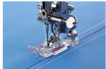
Einige Quilttechniken erfordern das Nähen auf kleinen Stoffteilen. Entfernen Sie die Führungen und nutzen Sie nur die Einteilungen des Fußes. Diese sind für 1/4" und 1/8" Nähte markiert.
