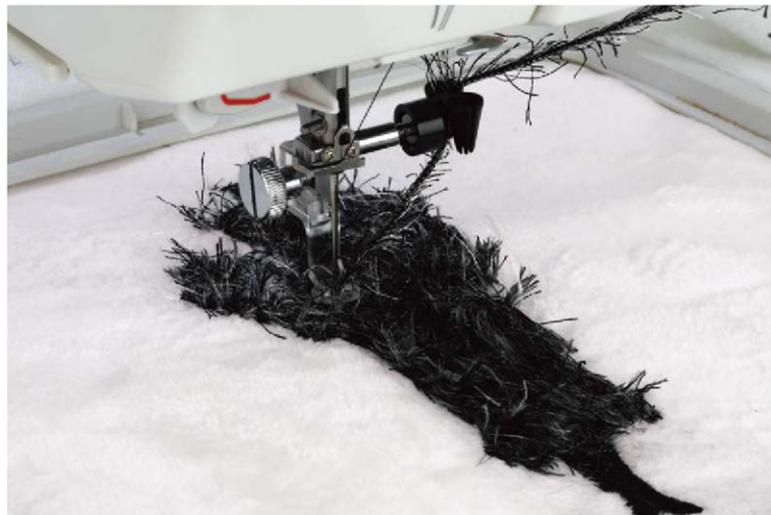
Bei Brush-Out-Stickerei wird Garn verwendet, das nach dem Nähen aufgeplustert werden kann, um ein weiches, dreidimensionales Ergebnis zu erzielen. Das Brush-Out Stickset enthält einen speziellen Fuß und eine Bürste, die zur Verwendung mit der Brush-Out Stickmuster CD-ROM von Stitchitize konzipiert ist.
