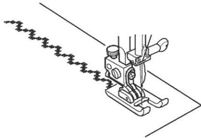
Der offene Applikationsfuß ermöglicht eine gute Sicht auf die Naht. Er wird gerne beim Quilten, Applizieren, für Monogramme und für Richelieustickerei benutzt.
