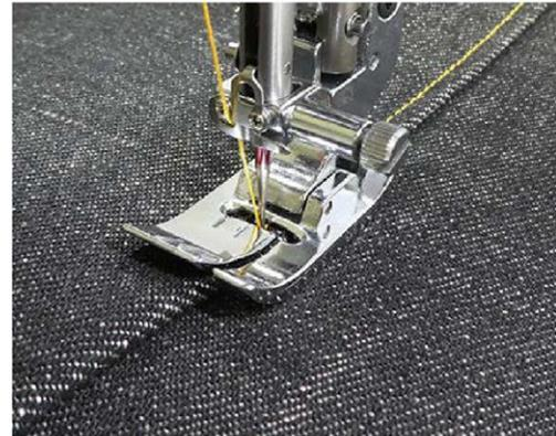
Dieser Fuß ermöglicht das Nähen mit einer konstanten Breite neben einer Stoffkante. Er führt perfekt Ihre Stepp- und Kantennähte. Dicke Materialien (z. B. Wolle, Denim, Tweed) können damit verarbeitet werden.
