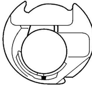
Verwenden Sie den Free-Motion-Fuß mit diesem optimierten Spulhalter zum Freihandquiltten. Er hat eine geringere Spannung und sorgt für schönere Stiche beim Freihandquiltten.
