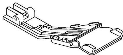
Nähen Sie Gürtelschlaufen wie in der Bekleidungsindustrie mit breitem oder dreifach-Coverstich. Der Fuß faltet Stoffbänder in die korrekte Form. Nähen Sie Gürtelschlaufen, Dekorelemente, Knopfschlingen, schmale Riemchen und Ähnliches. Die Möglichkeiten sind unzählig. Spielen Sie mit Ihrer Kreativität.
