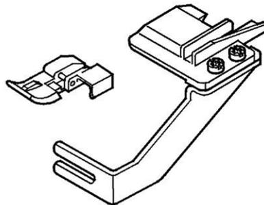
Das Perlenband-Set besteht aus einem Spezialfuß und der optimierten Führung zum Annähen von Perlenschnüren an Kanten. Es wird besonders gerne bei Brautmode, oder bei festlichen Taschen eingesetzt.
