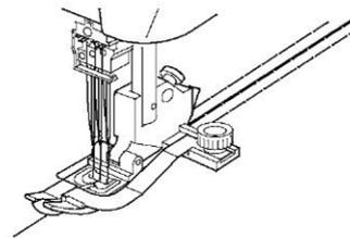
Der Mittenführungsfuß richtet Zwei- oder Dreinadelnähte an der Mitte einer zuvor genähten Naht aus. Der Anschlag läuft in der Naht, so entstehen exakte Steplinien im gleichen Abstand zur Mittellinie. Besonders bei Sportkleidung verstärkt diese Technik beanspruchte Nähte und wertet nebenbei diese Teile optisch und modisch auf.
