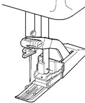
Der Einsatz dieses Fußes empfiehlt sich beim Nähen mehrerer Stofflagen unterschiedlicher Materialarten und Oberflächenstrukturen. Die spezielle Zahnung des Transporteurs und ein zweiter Transporteur auf der Fußunterseite unterstützen den Nähvorgang.
