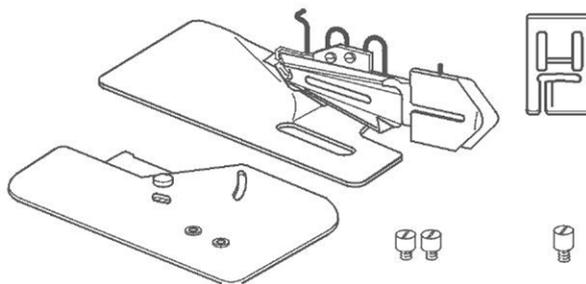
Mit dem Quilteinfasser-Set fassen Sie Quilts und dickere Stoffe mit einem 1/2" breiten Band ein. Mit den Schrauben stellen Sie den exakten Zulauf ein. Fädeln Sie das Band in die Führung und nähen Sie knappkantig das automatisch gefaltete Band an. Der Quilt oder dickere Stoff werden automatisch in den Falz geführt. So fassen Sie Ihre Quilts ein oder setzen Akzente bei z. B. Tischsets oder Topflappen.
