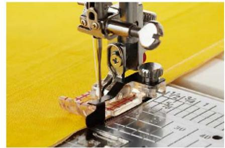
Einfach die 1/4" -Führung anbringen, die den Stoff exakt führt. Sie nähen damit schnell und schön 1/4" Nähte. Das ovale Stichloch erlaubt eine Feinjustierung bis zu 1 mm für knappkantige 1/4" Nähte.
