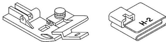
Säume ohne Messen, Stecken und Bügeln. Nur den Stoff korrekt einlegen. Die Führung faltet den Stoff und es entsteht ein 2,5 cm nach unten eingeschlagener Saum. Verwenden Sie den Coversaumfuß.
