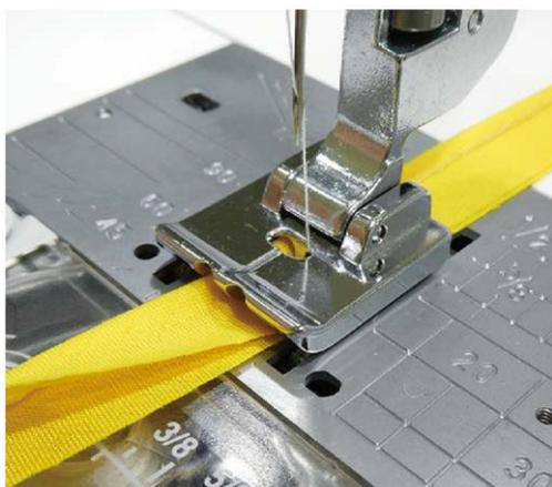
Mit diesem Fuß nähen Sie Paspel mit einem Kordel Durchmesser von etwa 2 mm. Er ist nützlich für die Herstellung von schmalen Paspeln aus demselben Stoff wie das Nähgut oder zum Annähen von Paspel Band an Stoff.
