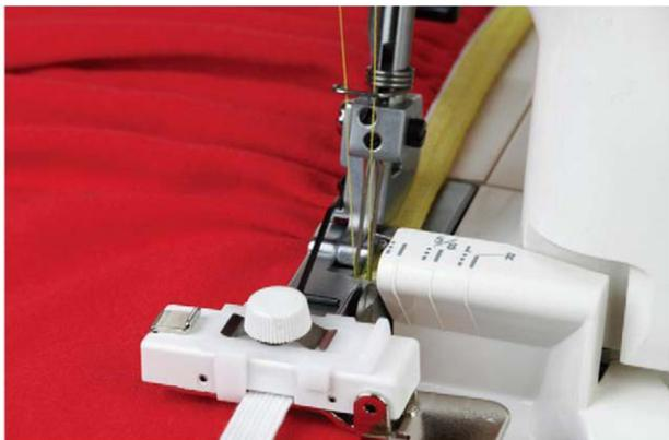
Gummibänder an elastische Stoffe annähen kann besonders knifflig sein, wenn die Länge exakt zur Naht passen muss. Der Gummibandkräusler vereinfacht diese Technik, indem er das Band für Sie hält, führt und gleichzeitig dehnt.
