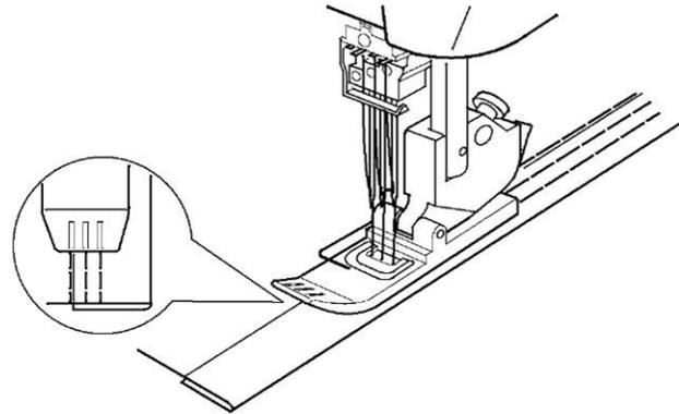
Der Klarsichtfuß ermöglicht gute Sicht auf die Näharbeit. Besonders geeignet für Dekornähte oder bei Nähten mit anderem Zubehör, wie der Saumführung, um Anfang und Ende einer Naht exakt abzustimmen. Die hilfreichen Markierungen vorne am Fuß entsprechen der Position der eingesetzten Nadeln zur optimalen Ausrichtung.
