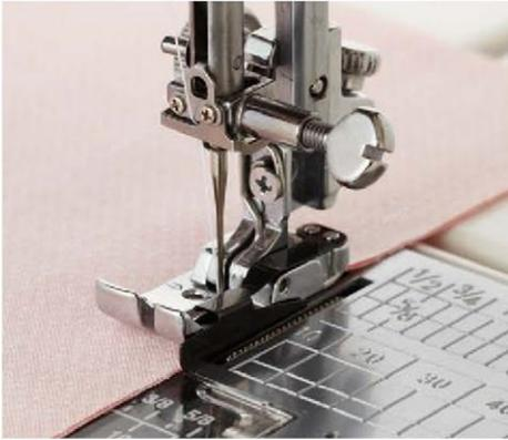
Ein beliebter Fuß bei Patchworkern für die wichtige 1/4"-Naht. Die Führung am Fuß ermöglicht es immer eine perfekte 1/4"-Naht zu nähen. Die Führung kann auch überall dort verwendet werden, wo eine 1/4"-Naht erforderlich ist, aber die Markierungen auf der Stichplatte nicht verwendet werden können, z. B. beim Nähen einer Flachnaht.
