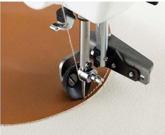
Der HD (Heavy Duty) Rollfuß ist ideal für das exakte Nähen von Kurven auf schwer gleitenden Materialien wie Leder oder beschichteten Stoffen. Das freistehende Rad ermöglicht präzises Nähen und eine freie Sicht auf das Nähgut.
