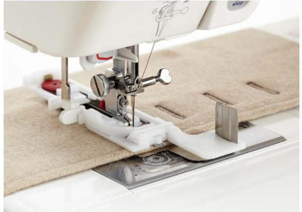
Setzen Sie den Automatikfuß R in die Halterung der Klemmschiene ein. Mehrere Lagen oder unebene Stoffe werden gleichmäßiger geführt. Die Maschine 'frisst' keine Stoffe oder näht auf der Stelle. Besonders gut um Knopflöcher an Kanten zu nähen.
