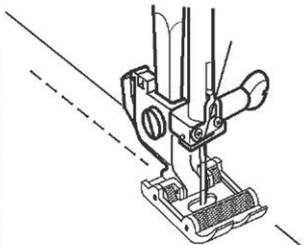
Wie der Name verrät, hat dieser Fuß Rollen und rollt damit über dicke Säume und unebene Oberflächen. Ideal zum Nähen von schwerem und dickem Material. Die Rollen gleiten über das Nähgut zwischen Fuß und Transporteur und gleichen Unebenheiten aus. Zusätzlich ist der Fuß beim Nähen von Kunstleder und Vinyl eine echte Erleichterung.
