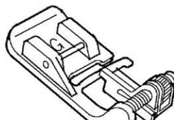
Blindsäume sind manchmal etwas schwierig. Der Blindstichfuß erleichtert das Nähen. Der Fuß hat eine Metallführung in der Mitte und drei Rillen auf der Unterseite. Diese drei Rillen leiten den Stoff zur Nadel und die Führung sorgt für eine akkurate Ausrichtung der Stoffkante.
