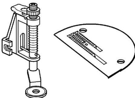
Der gefederte Fuß wird beim Freihandquiltten, Stippling und Freihandsticken verwendet. Die Stichplattenabdeckung wird auf die Stichplatte geklemmt, um den Transporteur auszuschalten.
