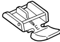
Dieser Fuß kann sowohl links als auch rechts am Reißverschluss verwendet werden. Die Kante des Fußes sorgt für die korrekte Platzierung des RVS.
