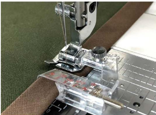
Mit diesem Fuß, nähen Sie Bänder an der Stoffkante an. Stellen Sie die Einfassbreite mit der Rändelschraube ein.
