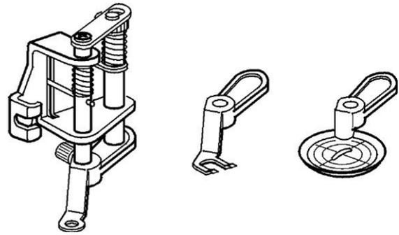
Dieses Set umfasst drei Sohlen zum Freihandquiltieren einer Vielzahl von unterschiedlichen Stoffen in Quiltprojekten. Wählen Sie den am besten passenden Fuß und befestigen Sie diesen schnell am Halter. Die Höhe des Fußes kann für alle drei Sohlen und die Dicke der Stofflagen angepasst werden, damit die Füße leicht über die Oberfläche der Projekte gleiten.
