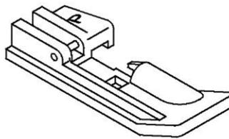
Perlenbesetzte Nähte geben Kleidung ein festliches Aussehen. Die tiefen Rillen an der Unterseite des Fußes führen Perlenchnüre oder Ketten perfekt in der Naht. Sie werden mit einer Flachnaht angenäht.
