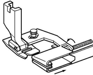
Mit diesem Fuß fassen Sie mit Bändern ein. Mit Hilfe einer Justierschraube wird der Abstand der Naht zur Bandkante justiert. Führen Sie mit der linken Hand den Stoff, mit der rechten das Band.
