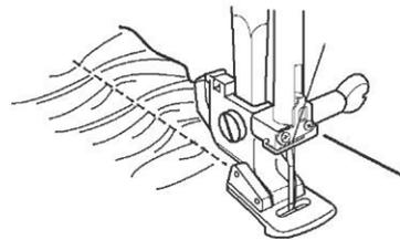
Dieser Fuß sorgt für feine Kräuselungen bei dünnen Stoffen. Die Kehle hinter der Nadel und die Verdickung davor sorgen für eine kleine Raffung, welche direkt auf einen feinen Unterstoff genäht werden können. Für starke Kräuselungen verwenden Sie einen Faltenleger.
