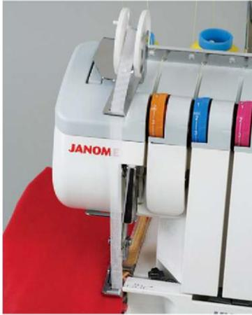
Dieser Aufsatz besteht aus einem Nähfuß und einem Bandroller, er ist praktisch beim Nähen von Kleidungsstücken aus Maschenware oder elastischem Stoff einsetzbar. Er hilft beim Zuführen von Nahtband an Schulternähten und Armausschnitten, um ein Ausdehnen in diesen Bereichen zu verhindern.
