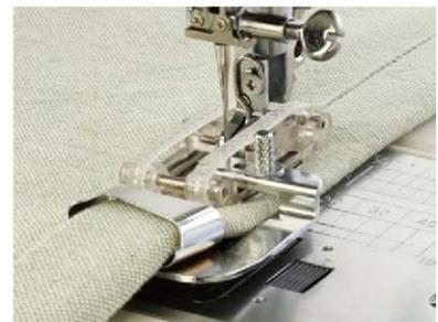
Mit diesem Zubehör sind Rollsäume mit 26 mm, 19 mm und 13 mm möglich.
