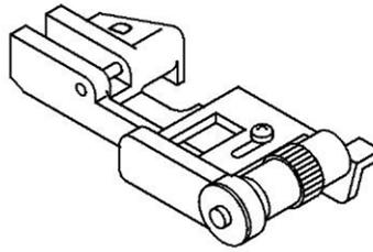
Die verstellbare Führung am Blindstichfuß sorgt dafür, dass in einer Arbeitsgang geschnitten, versäubert und blind gesäumt wird.
