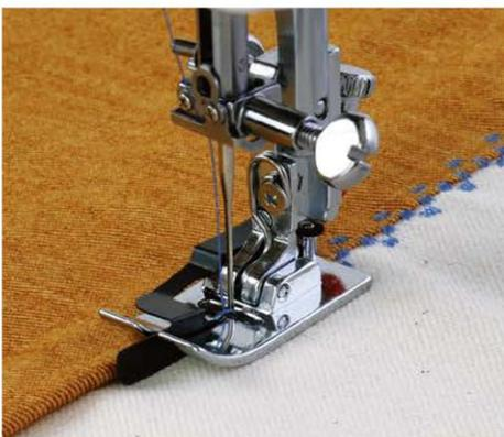
Ein wirklich nützlicher Fuß, zum Nähen in einer Schattennaht. Der Fuß ebnet beiderseitig der Führung die Stoffe und erleichtert das Nähen in der Naht. und ist auch nützlich, um Zierstiche entlang der Nähte zu nähen.
