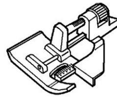
Die verstellbare Führung dieses Fußes sorgt für perfektes Absteppen von Kanten und Säumen mit gleichmäßigem Abstand. um den Abstand einzustellen, drehen Sie an der Schraube. Sie können Kanten und Säumen schön schmal absteppen.
