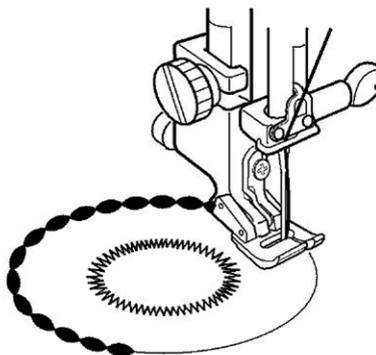
Dieser Nähfuß ist kürzer als die meisten anderen, damit Sie beim Applizieren leichter um Kurven und Ecken manövrieren können. Er ist aus durchsichtigem Kunststoff, damit Sie besser auf die Naht schauen können.
