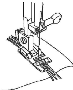
Der Kordelfuß nimmt unter der speziellen Spange 1 - 3 Kordeln auf, dort werden die Kordeln gehalten und genau unter Naht geführt. Unterschiedliche Nutz- und Zierstiche können zum Aufnähen eingesetzt werden. Die Auswahl von Kordel, Nähfaden und Stich sind die entscheidenden Faktoren für die endgültigen Effekte der Naht.
