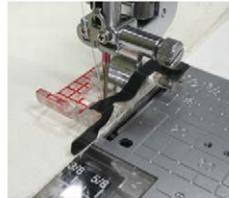
Mit diesem Fuß können mit der Geradstichplatte 1/4"-Naht nähen, die für Patchwork unerlässlich sind. Das kleine Stichloch sowohl in der Geradstichplatte als auch im Fuß sorgt für größtmögliche Kontrolle über den Stoff und ein geringes Risiko, dass sich Fäden oder Stoff im Transporteur verfangen.
