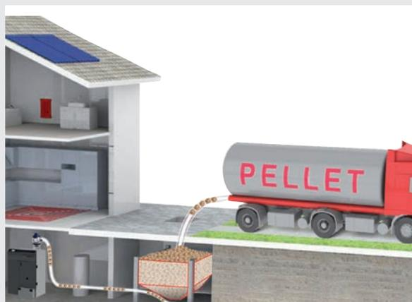
Ejemplo de aprovisionamiento de pellet mediante camión cisterna
