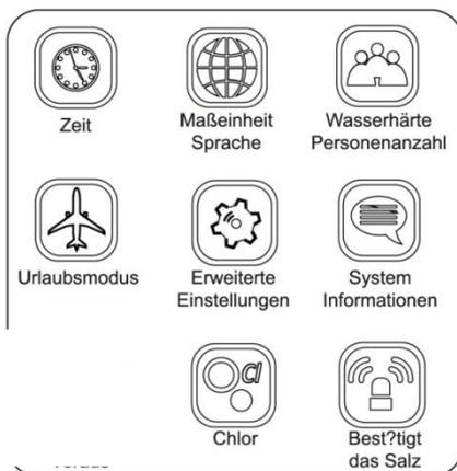
Durch Berühren von „Menu“ kommen Sie ins Hauptmenü der Anlage. Durch Auswahl von „Erweiterte Einstellungen“ Haben Sie die Wahl zwischen „Autom. Berechnung“ und „Manuelle Einstellung“. Wählen Sie den Menüpunkt mit Up und Down aus und berühren die Schaltfläche länger als 3 Sekunden. Dann schaltet die Anlage ins nächste Untermenü. Anzeige Chlor und Salz ist nicht bei allen Anlagen vorhanden. Wir empfehlen die automatische Einstellung.
