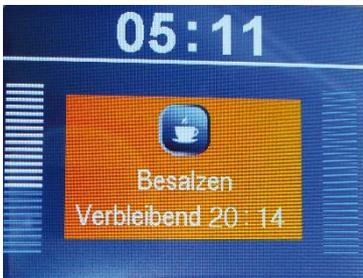
Wenn der Motor aufhört das Ventil zu positionieren, können sie den Bypass vorsichtig halb öffnen. Es wird Besalzen angezeigt
