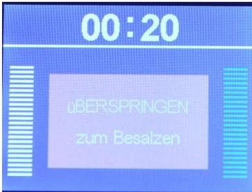
Geben Sie ca. 20 l sauberes Wasser in den Solebehälter der Anlage. Während der Positionierung des Ventils sehen Sie diese Anzeige.
