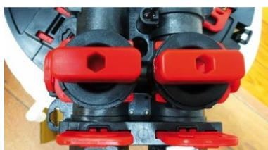
Nach Montage und Dateneingabe stellen Sie den Bypass in die „Bypass-Stellung. Öffnen Sie das Absperrventil vor der Anlage und prüfen Sie, ob die Anschlüsse dicht sind. Öffnen Sie ein Ventil nach der Anlage und spülen eventuelle Verunreinigungen aus. Warten Sie ein paar Minuten bis das Wasser klar ist.
