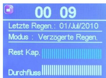
Schließen Sie die Anlage an die Stromversorgung an. Das Ventil startet und geht in die Betriebsstellung. Drücken Sie die Menütaste für 3 Sekunden. Die Elektronik piepst. Die Tastatur ist entsperrt. Drücken Sie jetzt SET/REGEN für 3 Sekunden.
