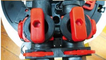
Jetzt öffnen Sie auch den Ausgang. Diese Stellung ist die normale Betriebsstellung. Sie haben aber noch Hartwasser, da die Anlage noch regeneriert.
