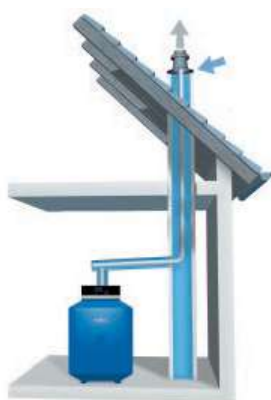
Raumluftunabhängige Aufstellvariante mit eingezogener Kunststoff-Abgasleitung im Schornstein.
