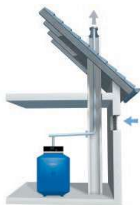
Raumluftabhängige Aufstellvariante mit eingezogenem Abgasrohr im Schornstein.
