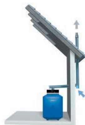
Raumluftunabhängige Aufstellvariante mit Rohr-in-Rohr-Kunststoff-Abgassystem entlang der Außenfassade.
