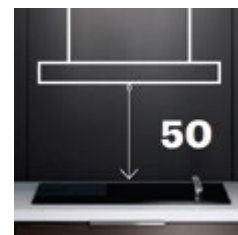
Distancia mínima 50 cm a placa de gas
