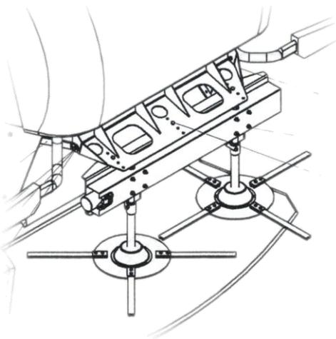
Der Bausatz besteht aus einem Balken mit Getrieben, welche die Verteiler über ein Zapfwellen Steckprofil aufnehmen.
