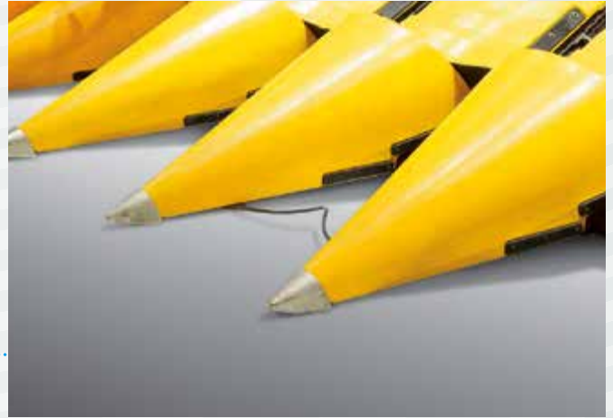
Reihenführungssystem für Mähdrescher mit Maispflückvorsatz.
