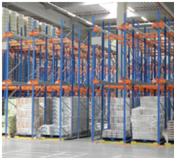
Installation dynamique pour palettes avec solution par navette au-dessus
