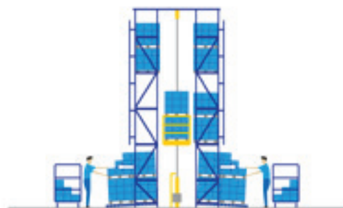
VNA avec retrait ou combiné avec système dynamique pour cartons
