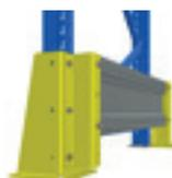
Un trafic intense sur les extrémités des rayonnages, voire dans les passages pont, occasionne souvent des dommages à l'installation. La protection d'extrémité stow est composée d'une lisse principale en profil sigma, boulonnée sur deux pieds. Des pieds intermédiaires sont rajoutés pour des longueurs plus importantes.
