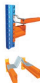
Des butées de palettes peuvent être utilisées dans les rangées simples ou doubles. Elles sont souvent mises en place pour protéger le mur du bâtiment, par exemple pour les cloisons des chambres froides, ou pour garantir l'espace entre les palettes dans les rayonnages doubles des installations sprinklées. Les butées peuvent également être utilisées comme support de fixation de contreventements ou panneaux fils sur la face arrière des rangées.
