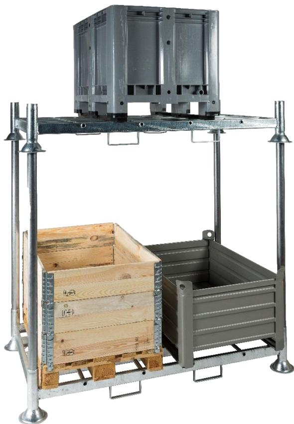
Les Manuracks doubles permettent de gerber deux palettes 800x1200 par niveau. Les palettes Manuracks doubles constituent un système simple, robuste, mobile, démontable qui peut être installé sous forme d'une aire de stockage traditionnelle avec allées de circulation ou en stockage de masse par accumulation. La base palette peut recevoir 3 longueurs de tubes interchangeables (1050mm, 1680mm ou 2100mm) et adaptables à la hauteur de vos charges.
