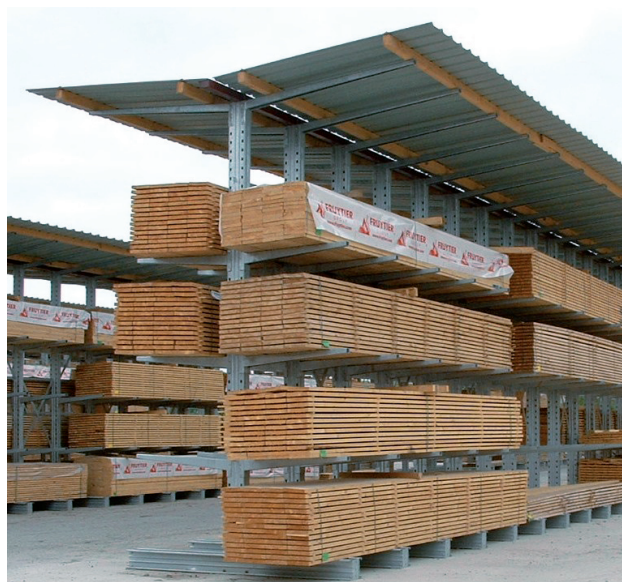
Cantilever galvanisé à chaud
