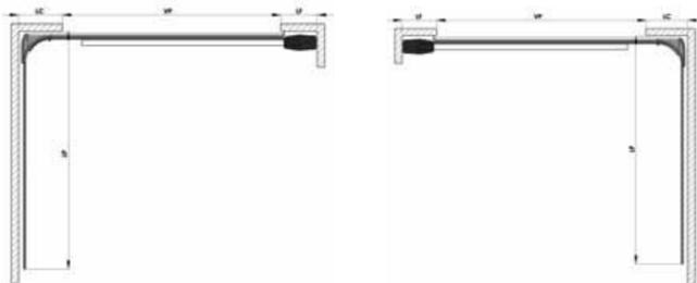
Legenda | LC - Lateral lado curva LF - Lateral fecho VP - Vão porta DM - Medida da parede com motor DP - Medida da parede p/porta manual P - Padieira
