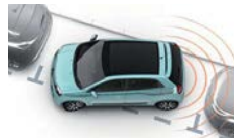
Aide au parking arrière (disponible sur Intens et dans le Pack City sur Zen)
