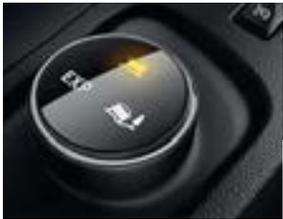
Indispensable pour optimiser sa motricité en condition de roulage difficile (boue, sable,...), le système Extended Grip agit sur le couple moteur et l'antipatinage. Une molette permet de choisir entre les modes « toutes routes », « sol meuble » ou « mode expert ».
