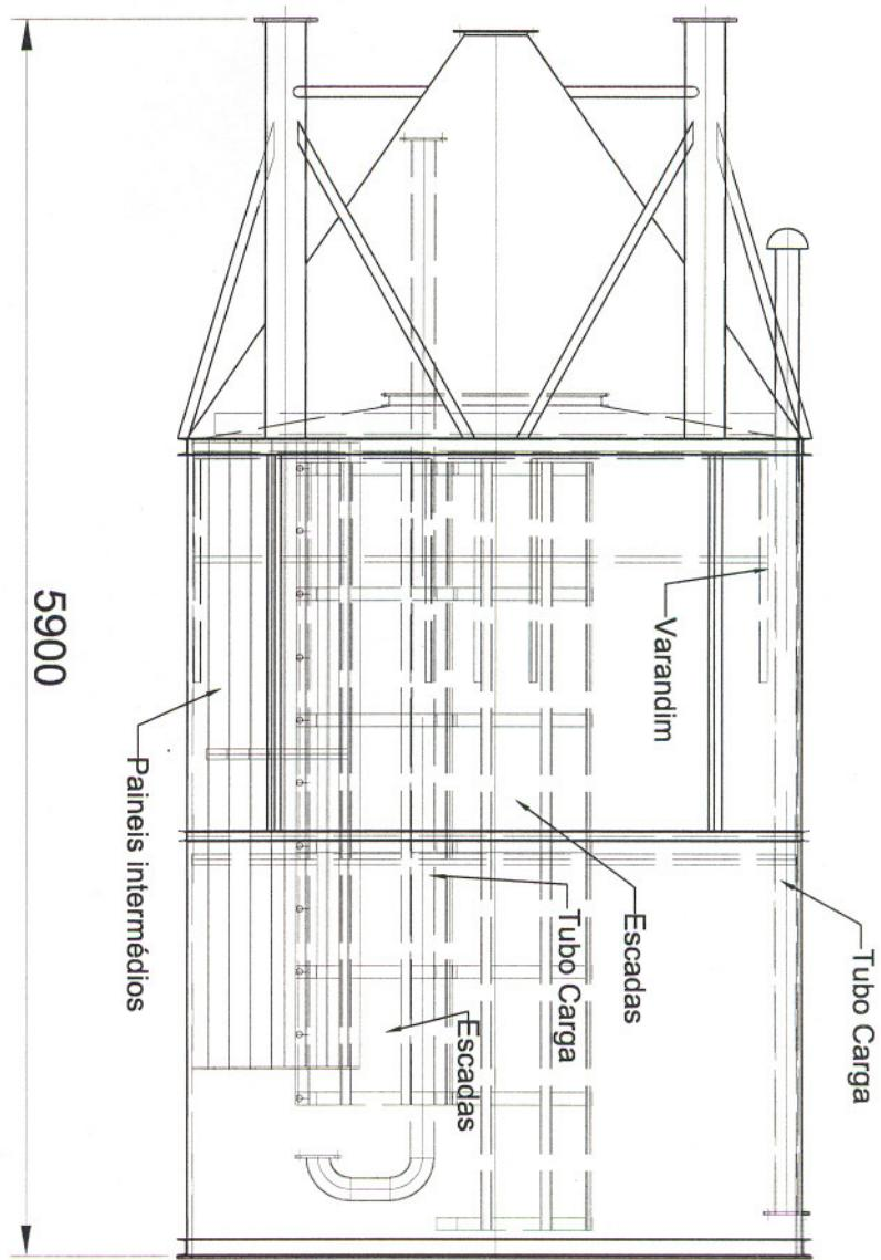
Silo telescópico 100 Ton. com painéis intermédios desmontável, de modo a permitir carga de 2 silos em Flat de 40"
