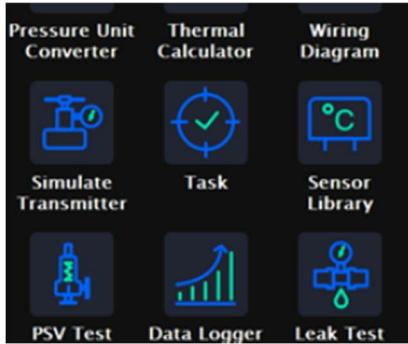
Die ADT227-Serie ist mit zeitsparenden Funktionen ausgestattet, wie z.B. einem eingebauten Druck- und Temperaturumwandler, einem thermischen Rechner, einer Schaltplananleitung zur Unterstützung bei elektrischen Anschlüssen, einem eingebauten Diagnosezentrum mit intelligenter Alarmmeldung, einem Echtzeit-Fehlerbericht sowie einem umfassenden Selbsttest.
