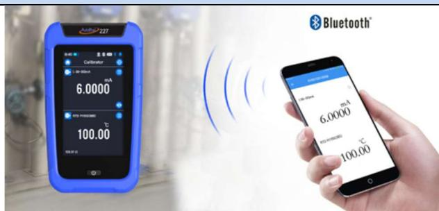
Benutzer können mobile Geräte über Bluetooth mit dem ADT227 über eine ungehinderte Entfernung von bis zu 20 Metern verbinden. Der mitgelieferte USB-Typ-C-Kommunikationsanschluss und das Kabel bieten die Möglichkeit, den herausnehmbaren Li-Ionen-Akku aufzuladen. (Akkulaufzeit bis zu 35 Stunden).
