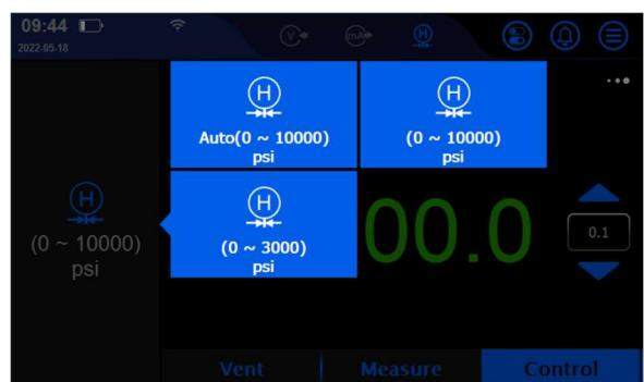
Die Auswahl des Druckbereichs kann auf den "Auto"-Modus eingestellt werden, so dass der Kalibrierungsbereich automatisch vom ADT762W auf der Grundlage des Solldrucks ausgewählt wird. Ebenso kann der Kalibrierungsbereich manuell ausgewählt werden.
