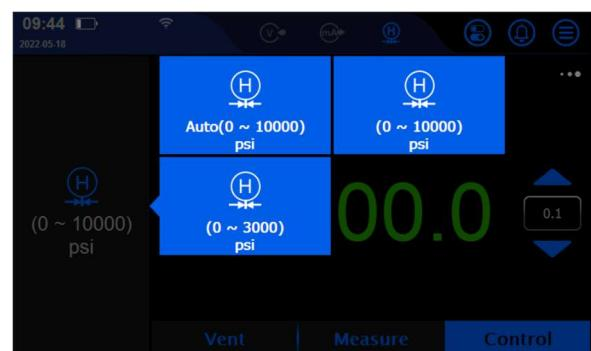
Die Auswahl des Druckkalibrierungsbereichs kann auf den "Auto"-Modus eingestellt werden, so dass der Kalibrierungsbereich automatisch vom ADT762 auf der Grundlage des Solldrucks ausgewählt wird. Ebenso kann der Kalibrierungsbereich manuell ausgewählt werden.
