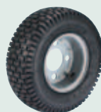
Pneu avant 1911K4-7 Pour une utilisation en extérieur (pelouse ou chemins).
