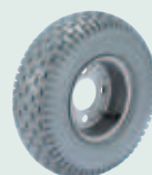
Pneu avant 1911K5-5 Pour une utilisation en intérieur, permet d'éviter les traces noires.
