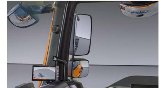
Die Video-Abbiegehilfe (VTA) ist ein Standalone-System für Fahrzeuge, die bisher über keine Abbiegeassistenzsysteme verfügen. Verfügt das Fahrzeug schon über eine serienmäßig verbaute Abbiegehilfe bietet sich das Seitenkamarasystem (SCS) zur Nachrüstung an.
