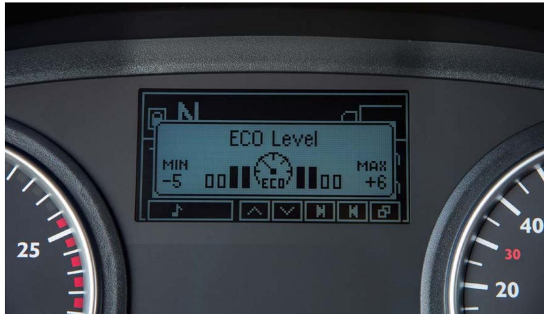
Der GPS-gesteuerte Tempomat erkennt durch gespeichertes Kartenmaterial Steigungen und Gefälle der vorausliegenden Strecke und passt die Geschwindigkeit kontinuierlich dem aktuellen Streckenverlauf an. Es entlastet den Fahrer, ist leicht zu bedienen und bietet einen harmonischen Fahreindruck und höchsten Fahrkomfort.
