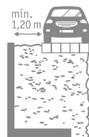
E | (ausgenommen 55-105 cm); Verkehrslast bis p = 5 \text{ kN/m}^2 , mit Ver- dichtungserddruck e_{vh} = 25 \text{ kN/m}^2 , Abstand: 1,2 m (bis 155 cm Höhe)/1,5 m (ab 180 cm Höhe)
