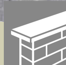
Mauerabschluss mit Abdeckplatten
