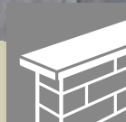
Mauerabschluss mit Abdeckplatten
