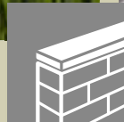
Mauerabschluss mit Abdeckplatten
