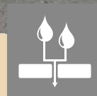
Versickerung durch die Fuge Abflussbeiwert C=0,1
