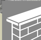
Mauerabschluss mit Abdeckplatten
