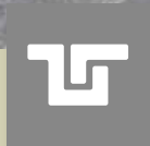
Verbundwirkung Nut- und Feder
