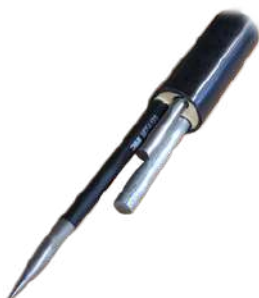
Enrouleur de câble avec poignée témoin, électrode, pointerolle
