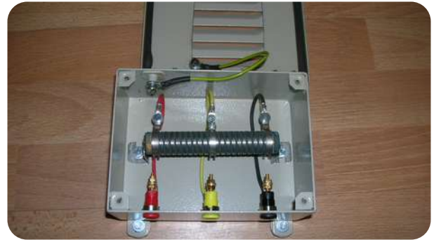
Coffret résistance ajustable sortie douille de mesure
