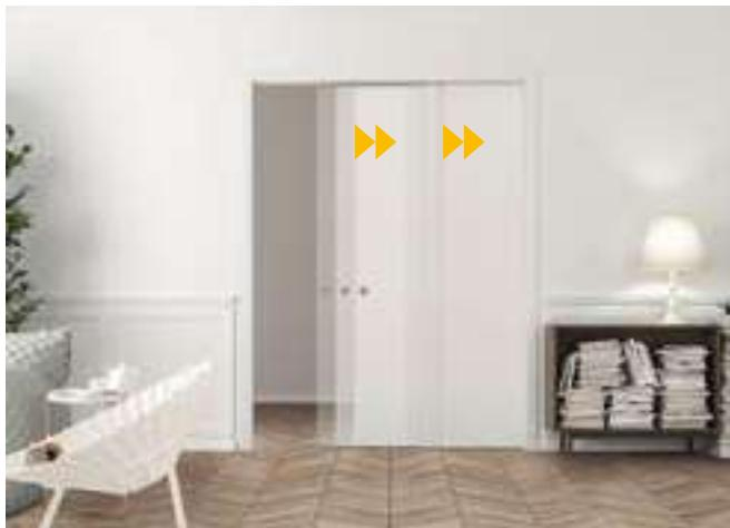
Der Synchronlauf für Teleskop-Innenwand-Schiebetürsysteme ermöglicht die gleichzeitige und harmonische Bewegung der beiden in dieselbe Richtung sanft und gleichmäßig gleitenden Türblätter: Der erste Türflügel bewegt sich bis zum „Anschlag“, um dann das zweite Türblatt mitzunehmen. Er kann direkt auf den Türblättern installiert werden, ohne dass die Schiene ausgetauscht werden muss.
