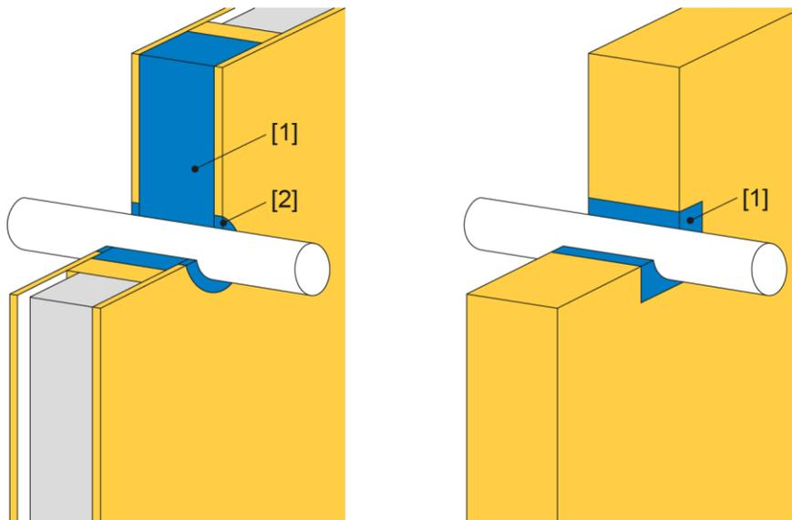
[1] Hohlraum ausgefüllt mit Mineralwolle, Schmelzpunkt  $\geq 1000\text{ °C}$ , Rohdichte  $\geq 40\text{ kg/m}^3$
