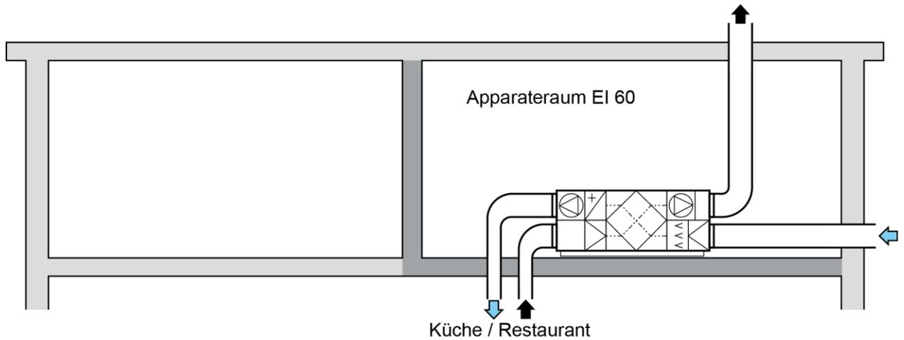
Abzuführende Gesamtabluftmenge 4'001 bis 12'000 m<sup>3</sup>/h
