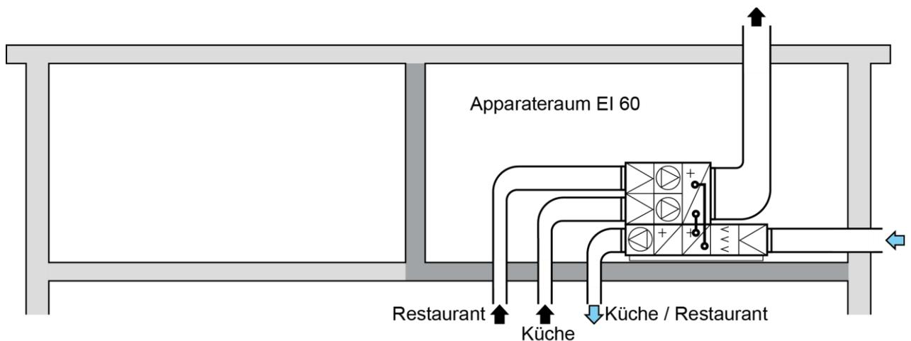
Abzuführende Gesamtabluftmenge über 12'001 m<sup>3</sup>/h
