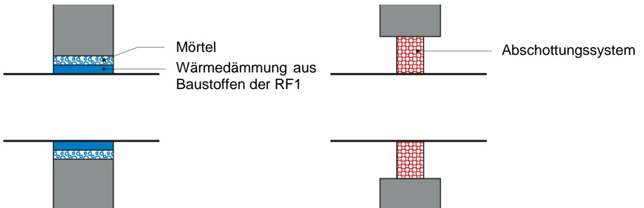
Durchführungen durch brennbare Bauteile
