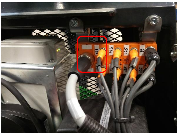
Kuva 25:Haaroitusrasia, tukijalkavalvonnan liittimet merkitty punaisen kehiksen sisään
