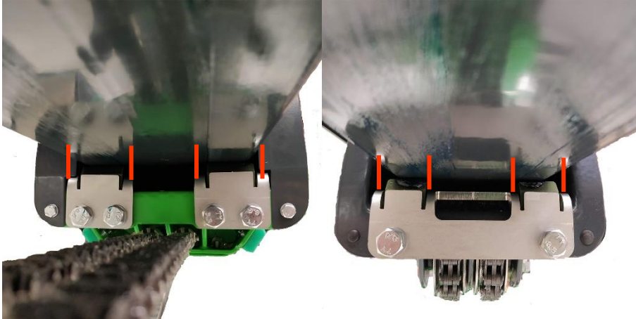
Kuva 18 Välipuomin ja jatkeen rasvattavien liukupintojen reunaviivat rajattu punaisella.
