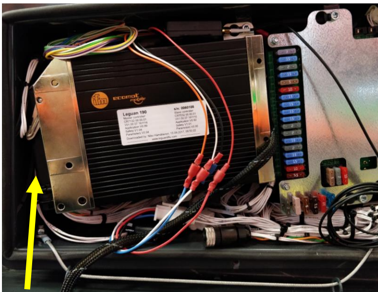
Kuva 32. Logiikkaohjaimien liittimet (2 kpl), osoitettu nuolella
