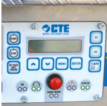
ECRAN DE DIAGNOSTIC INTÉGRÉ DANS PANNEAU DE COMMANDE
