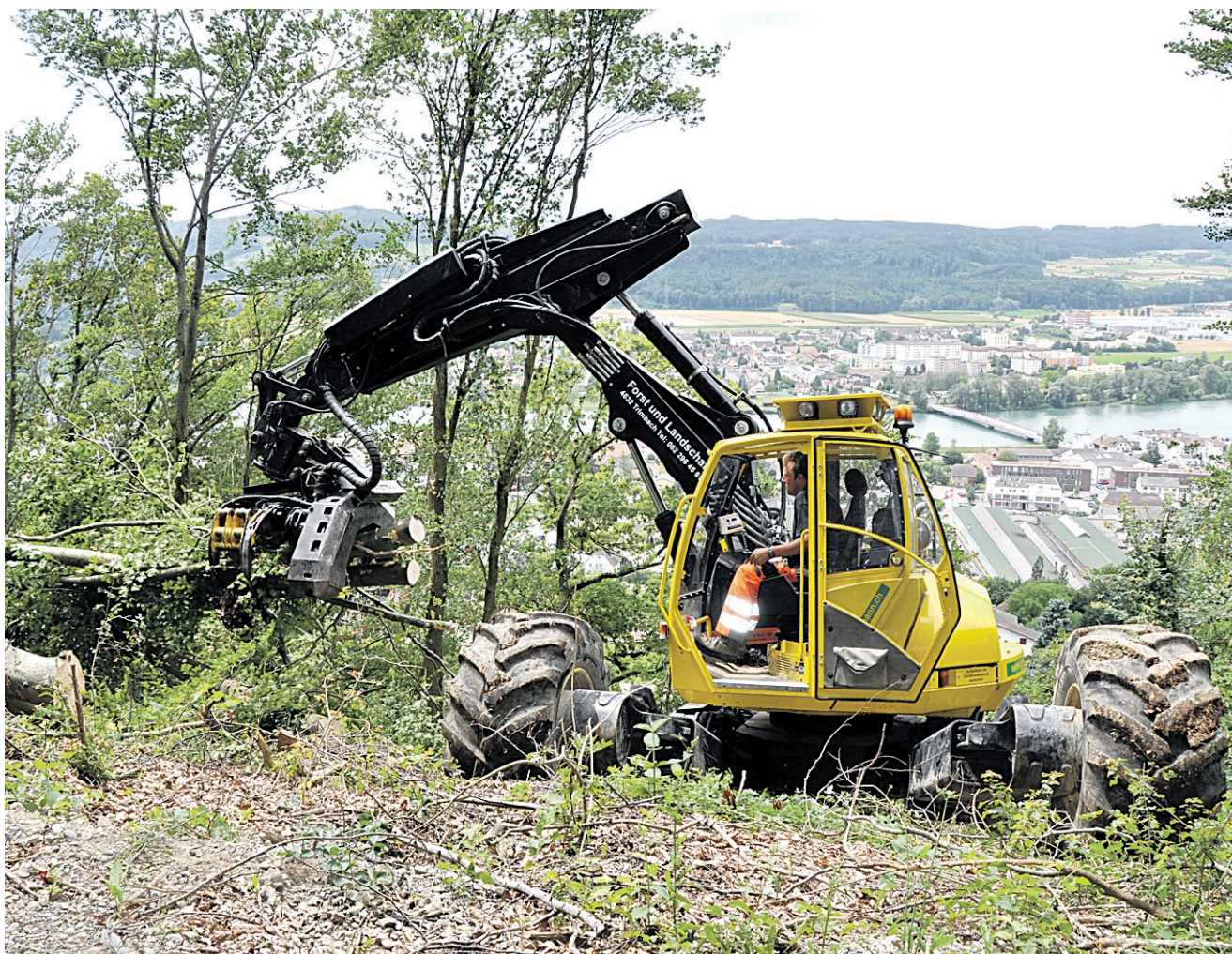
Der Schreitbagger macht einen schonenden Eingriff im steilen Hang möglich.
