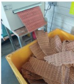
Machine de transformation de déchets de carton pour éviter l'emploi des matériaux de calage polluants tels que le polystyrène et le plastique.
