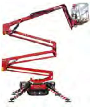
Este tipo de brazos son plataformas de trabajo aéreo montadas en un chasis con orugas, proporcionando estabilidad y movilidad en terrenos difíciles. Ideales para operar en superficies irregulares y fangosas.
