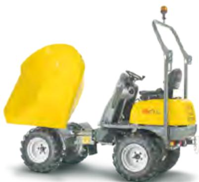
Estos modelos de dumper se adaptan perfectamente a múltiples terrenos, además el modelo de cubeta giratoria permite al Dumper Hidráulico la Descarga Trilateral
