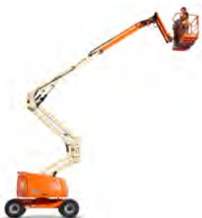
Los brazos telescópicos articulados a gas-oil son plataformas de trabajo aéreo que combinan segmentos telescópicos y articulados, permitiendo un alcance flexible y extendido. Funcionan con motores a gas-oil, proporcionando alta potencia y autonomía para uso en exteriores y terrenos difíciles.
