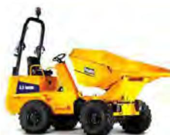
Dumper articulado 4x4 con una capacidad de carga de 3.000 Kg, muy eficiente y robusto, es perfecto para trabajos todoterreno.
