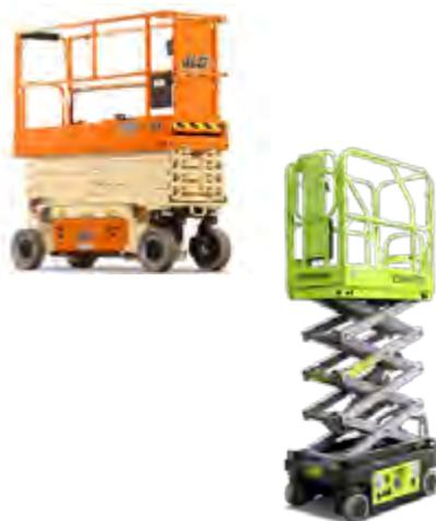
Equipo de elevación que utiliza un mecanismo de tijera para levantar una plataforma de trabajo. Impulsadas por motores eléctricos, son más silenciosas y ecológicas.
