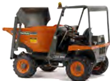
Con varias capacidades de carga y pala autocargable, destaca por su tracción 4x4. Dispone de transmisión hidrostática y es ideal para obras en urbanizaciones, rehabilitaciones o pequeña obra civil.
