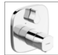
HANSALIVING Fertigmontageset mit Funktionseinheit Wannen-Thermostat- Batterie, DN 15 (G 1/2) mit Sicherungseinrichtung passend zu HANSABLUEBOX Einbaukörper* 8114 3572 verchromt mit integrierter keramischer Mengenregulierung, schraubenlose Rosette, Rosette soft edge - weiche Kanten - abgerundet, Funktionseinheit mit BLUESWITCH Umstellung und Abspernung
