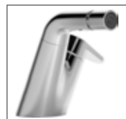
HANSASIGNATUR Einhand-Einlochbatterie für Bidet, DN 15 5508 3203 verchromt Ablaufgarnitur (Metall), Anschluss mit flexiblen Druckschläuchen Ausladung: 144 mm
