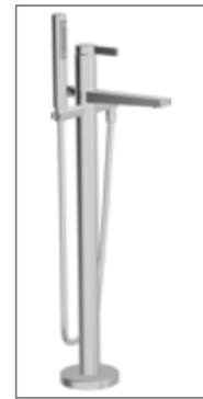
HANSALOFT Einhand-Wannen-Batterie, DN 15 G1/2* 5776 2073 verchromt bodenstehend Ausladung: 197 mm
