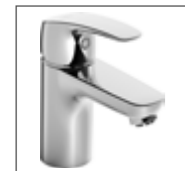
HANSAPINTO Waschtisch-Einhand- Einlochbatterie, DN 15 4534 1183 verchromt Ablaufgarnitur (Metall), flexible Anschlussschläuche, HANSA 35-Installation Ausladung: 107 mm
