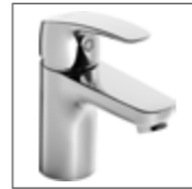
HANSAPINTO Waschtisch-Einhand- Einlochbatterie, DN 15 4506 2283 verchromt ohne Ablaufgarnitur, Anschluss mit flexiblen Druckschläuchen, HANSA 35-Installation Ausladung: 107 mm
