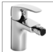
HANSAPINTO Einhand-Einlochbatterie, DN 15 für Sitzwaschbecken 4507 3283 verchromt Ablaufgarnitur (Metall), Anschluss mit flexiblen Druckschläuchen, HANSA 35-Installation Ausladung: 106 mm
