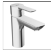
HANSA LIVING Waschtisch-Einhand- Einlochbatterie, DN 15 0613 1103 verchromt Ablaufgarnitur (Metall), Anschluss über Kupferrohre Ausladung: 108 mm
