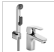
HANSAPINTO Waschtisch-Einhand- Einlochbatterie, DN 15 4505 2283 verchromt mit Funktionsbrause, Anschluss mit flexiblen Druckschläuchen, ohne Ablaufgarnitur, HANSA 35-Installation Ausladung: 107 mm
