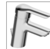
HANSAVANTIS Waschtisch-Einhand-Einlochbatterie, DN 15 für offene Heißwasserbereiter 5246 1173 verchromt Ablaufgarnitur (Metall), Anschluss über Kupferrohre Ausladung: 102 mm
