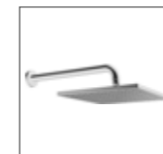
HANSAVIVA Kopfbrause, DN 15 4426 0340 verchromt Brausekopf, Messing quadratisch 250 x 250 mm Ausladung: 357 mm
