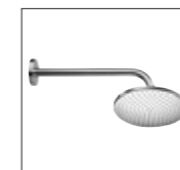
HANSARAIN Kopfbrause, DN 15 0418 0100 verchromt Brausekopf, Messing Ø 220 mm Ausladung: 400 mm
