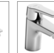
HANSAPOLO Waschtisch-Einhand- Einlochbatterie, DN 15 5140 2293 00676 verchromt Ablaufgarnitur (Metall), Anschluss mit flexiblen Druckschläuchen Ausladung: 103 mm
