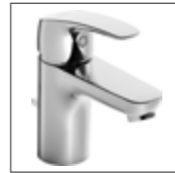
HANSAPINTO Waschtisch-Einhand- Einlochbatterie, DN 15 4504 2283 verchromt ohne Ablaufgarnitur, Anschluss mit flexiblen Druckschläuchen, HANSA 35-Installation Ausladung: 107 mm
