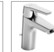
HANSAPOLO XL Waschtisch-Einhand- Einlochbatterie, DN 15 5150 2293 verchromt Ablaufgarnitur (Metall), Anschluss mit flexiblen Druckschläuchen Ausladung: 110 mm
