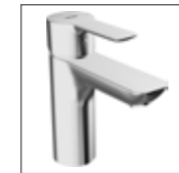
HANSA LIVING Waschtisch-Einhand- Einlochbatterie, DN 15 0609 2103 verchromt ohne Ablaufgarnitur, Anschluss über Kupferrohre Ausladung: 108 mm
