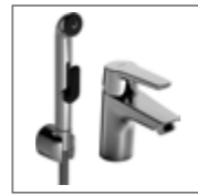
HANSAPOLO Waschtisch-Einhand-Einloch-Batterie, DN 15 5146 2293 verchromt mit Funktionsbrause, Anschluss mit flexiblen Druckschläuchen, ohne Ablaufgarnitur Ausladung: 103 mm
