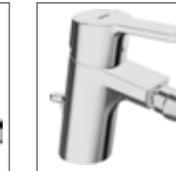
HANSAPRIMO Einhand-Einlochbatterie, DN 15 für Sitzwaschbecken 4943 3203 verchromt Ablaufgarnitur (Metall), Anschluss über flexible Druckschläuche Ausladung: 107 mm
