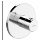
HANSAHOME Unterputz-Thermostat-Batterie, DN 15 (G 1/2) ohne Mengenregulierung, passend zu HANSABLUEBOX Einbaukörper* 8860 9045 verchromt schraubenlose Rosette, Rosette rund, Ø 170 mm, Funktionseinheit ohne Umstellung, ohne Absperrung
