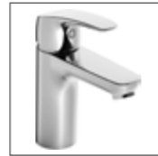
HANSAPINTO XL Waschtisch-Einhand- Einlochbatterie, DN 15 4502 2283 verchromt ohne Ablaufgarnitur, Anschluss mit flexiblen Druckschläuchen, HANSA 35-Installation Ausladung: 115 mm
