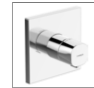
HANSALIVING Fertigmontageset mit Funktionseinheit Thermostat-Batterie, DN 15 (G1/2) passend zu HANSABLUEBOX Einbaukörper* 8112 9573 verchromt schraubenlose Rosette, Rosette quadratisch, 150 x 150 mm, Funktionseinheit ohne Umstellung, ohne Abspernung
