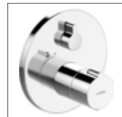
HANSAHOME Unterputz-Thermostat-Batterie, DN 15 (G 1/2) passend zu HANSABLUEBOX Einbaukörper* 8861 9045 verchromt mit integrierter keramischer Mengenregulierung, Funktionseinheit mit Absperrung, ohne Umstellung, schraubenlose Rosette
