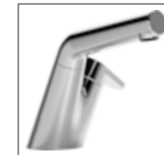
HANSASIGNATUR Waschtisch-Einhand-Einlochbatterie, DN 15 5505 2281 verchromt Ablaufgarnitur mit Push-Betätigung, herausziehbare Schlauchbrause, Ablaufgarnitur mit Push-Betätigung Ausladung: 168 mm
