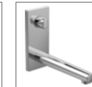
HANSASIGNATUR Fertigmontage-Set mit Funktionseinheit Waschtisch-Elektronik-Batterie für Wandeinbau, DN 15 (G 1/2) Netzbetrieb passend zu HANSAMATRIX Einbaukörper* 4491 2010 verchromt mit thermostatischer Temperaturmischung, berührungslos elektronisch gesteuert (Infrarot), inkl. Netzteil und Anschlusskabel Ausladung: 195 mm
