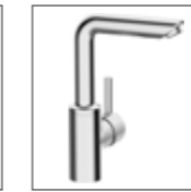
HANSAVANTIS STYLE Waschtisch-Einhand-Einlochbatterie, DN 15 5255 2287 verchromt Pin-Bedienungshebel (Metall), ohne Ablaufgarnitur, Anschluss mit flexiblen Druckschläuchen Ausladung: 139 mm
