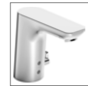
HANSA LIVING Waschtisch-Elektronik- Batterie, DN 15 Netzbetrieb 0615 2211 verchromt berührungslos elektronisch gesteuert (Infrarot), mit Ablaufgarnitur (Metall) Ausladung: 110 mm
