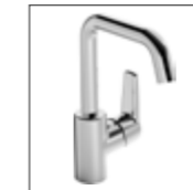
HANSAPOLO Waschtisch-Einhand- Einlochbatterie, DN 15 5154 2293 verchromt ohne Ablaufgarnitur, Anschluss mit flexiblen Druckschläuchen Ausladung: 152 mm
