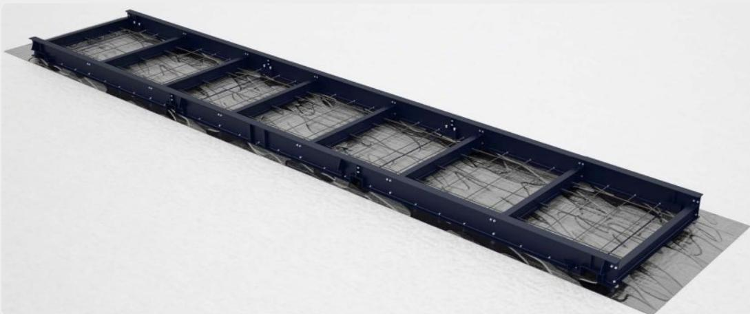
2. Colocación de las armaduras y hormigonado.
