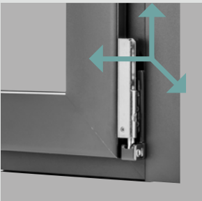
Réglage tri-dimensionnel du palier d'angle : réglage latéral, en hauteur et en compression
