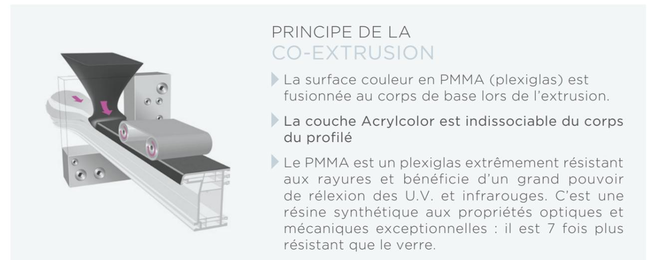
PRINCIPE DE LA CO-EXTRUSION
