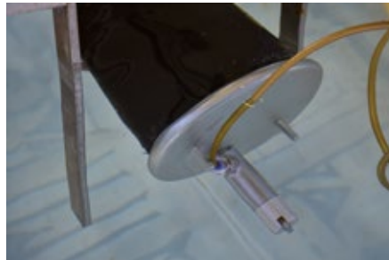
Control completo de estanqueidad en tanque de agua a una presión de 1,0–1,5 bares
