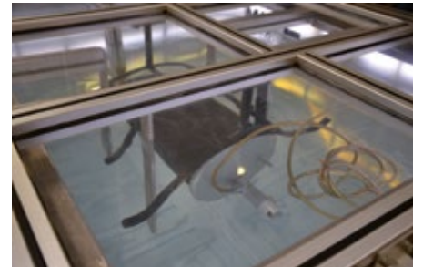
Control completo de estanqueidad en tanque de agua a una presión de 1,0–1,5 bares
