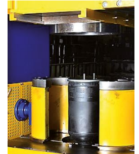
Finalmente, se abre la prensa. Ya se puede retirar el muelle neumático rebordeado.
