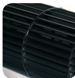
Sisäyksikön puhaltimien siivekkeet 10 vuoden jälkeen ilman pinnoitusta.
