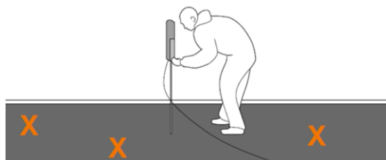
Figure 2 - Vérification de l'horizontalité finale
