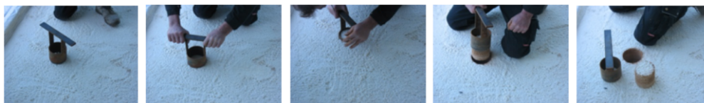
Figure 6 - Prélèvement des éprouvettes par carottage
