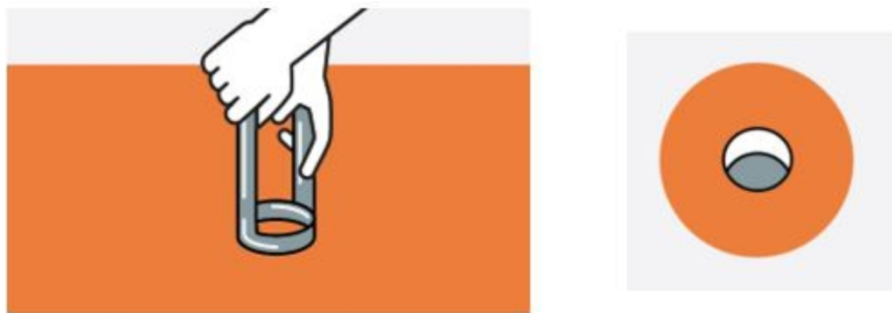
Figure 3 : Prélèvement des éprouvettes par carottage
