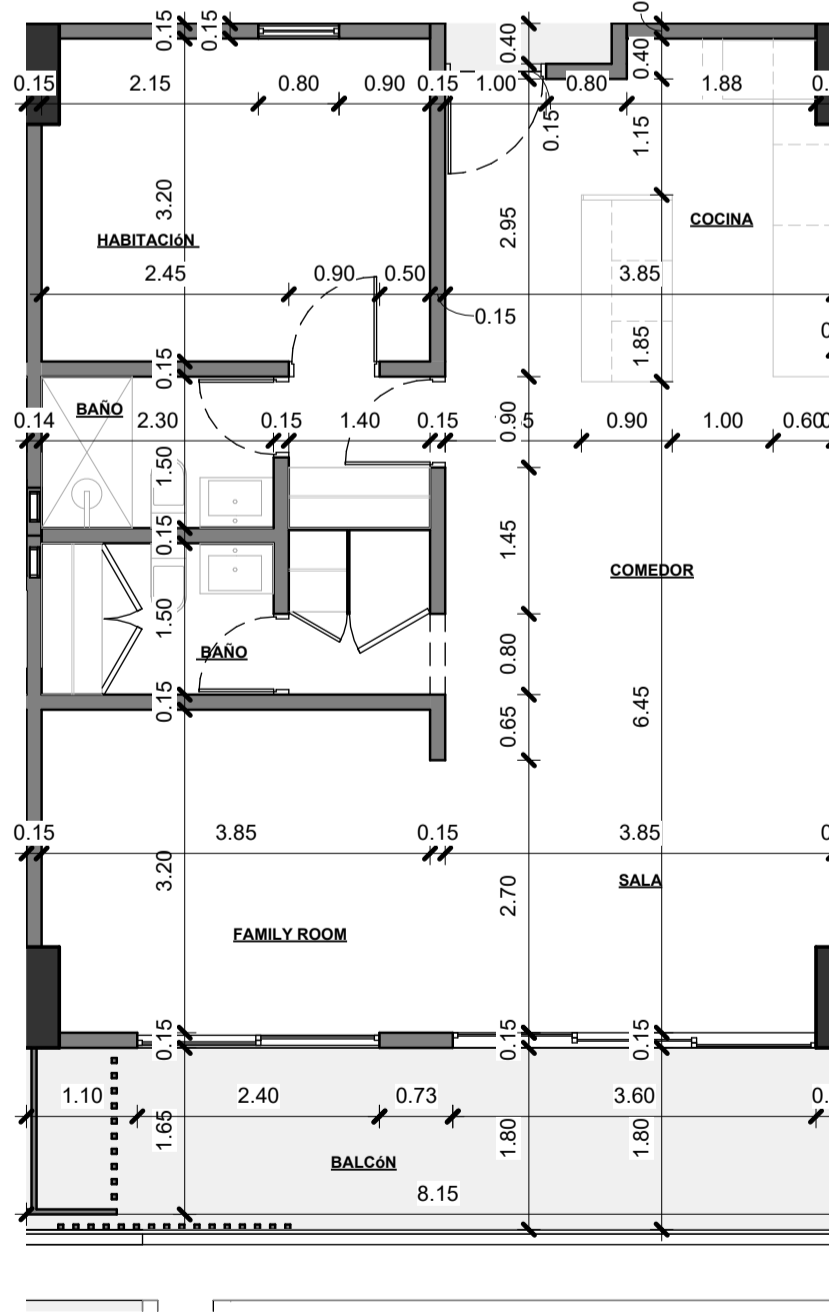
5 Planta Dimensionada - Tipología B 77M2 1:75
