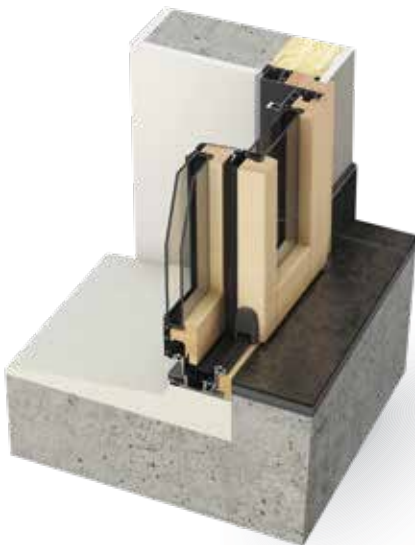
Pose en applique avec encastrement (36 mm)
