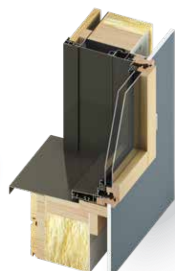
Adaptation pour mur ossature bois (HEMOB)
