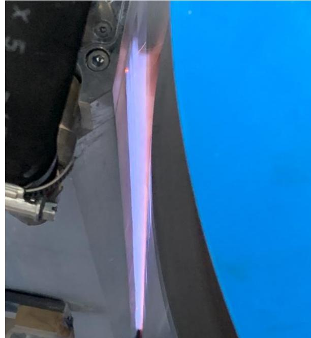
Aufbringen einer konsistenten SiO<sub>2</sub> –Schicht auf eine Bandbreite von AL-Legierungen zum Zwecke der Haftungsverbesserung von Klebstoffen auf dem Substrat zur Herstellung von bspw. Tiernahrungsverpackungen.
