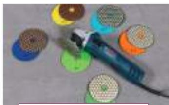
Disqueuse avec disque diamant
