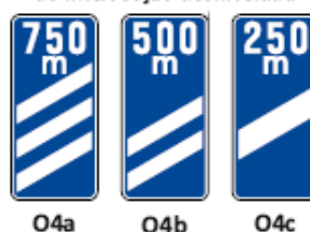
Sinal de aproximação de saída de intersecção desnivelada
