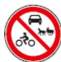
C4c - Trânsito proibido a automóveis, a motocicletas e a veículos de tração animal
