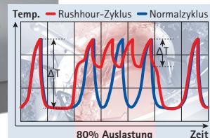
Rushhour-Modus: Das Gerät „merkt“ sich hohe Auslastungszeiten und heizt künftig entsprechend vor. Dies verkürzt die Prozessdauer und bringt mehr Durchsatz, bei verringertem Energiebedarf.
