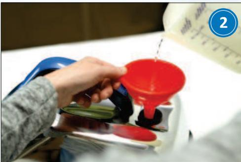
Nehmen Sie den Tankdeckel (01) vom THERMIO STAR® ab und befüllen Sie den Wassertank mit mindestens 1 Liter Wasser. Sie können reines Leitungswasser, destilliertes oder Osmose-Wasser verwenden. Füllen Sie bitte **keinerlei und niemals Chemikalien** in Ihren Thermostar.
