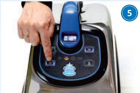
Betätigen Sie den Hauptschalter (02) an der Hinterseite des Gerätes, den Schalter (06A) und den Dampfkesselschalter (06B) und warten Sie ca. 2-4 Minuten bis die Kontrollleuchte (06D) aufleuchtet. Diese zeigt an, dass Dampf im Kessel ist. Die Schalter (11A und 11E) auf dem Handgriff sollten ausgeschaltet sein.
