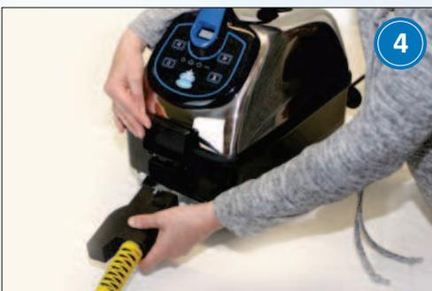
Stecken Sie den Dampfanschluss-Stecker (12) in den für das Zubehör vorgesehenen Anschluss (05) auf dem Gerät. Fest drücken, damit der Fixierknopf (13) einrastet.
