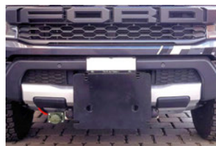
Piastra di montaggio conforme alla norma VSS, misura C, in versione ad innesto per Ford Raptor 4×4
