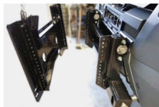
Piastra di montaggio conforme alla norma VSS, misura A, per autocarro M.A.N. TGS 18.430 6×4*4
