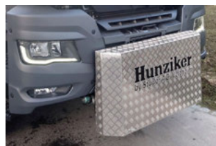
Piastra di montaggio conforme alla norma VSS, misura A, per autocarro M.A.N. TGS 18.430 6×4*4
