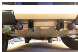
Piastra di montaggio conforme alla norma VSS, misura C, in versione ad innesto per Ford Raptor 4×4
