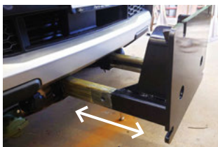
Piastra di montaggio conforme alla norma VSS, misura C, in versione ad innesto per Ford Raptor 4×4
