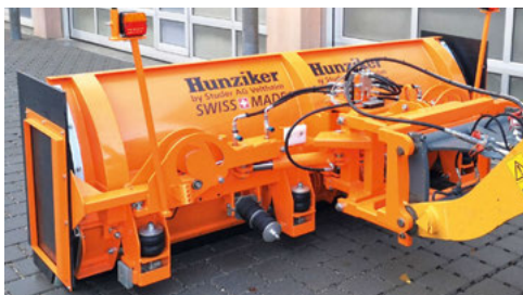
H2SH-280 SF: Barriere di espulsione sollevate (rimozione unilaterale) e abbassate (rimozione dall'area)
