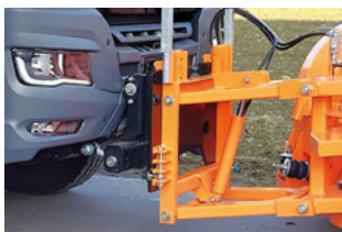
Piastra di montaggio conforme alla norma VSS, misura A, per autocarro M.A.N. TGS 18.430 6×4*4
