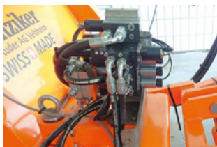
Comandi elettroidraulici proporzionali o a due punti, a seconda delle esigenze del cliente
