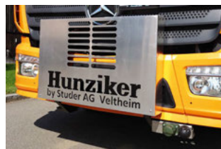
Piastra di montaggio conforme alla norma VSS, misura A, per autocarro Mercedes ATEGO 1530 4×2
