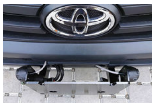
Piastra di montaggio conforme alla norma VSS, misura C, in versione fissa su un Toyota Hilux 4×4
