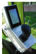
Comandi elettroidraulici proporzionali o a due punti, a seconda delle esigenze del cliente
