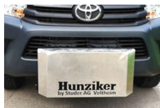
Piastra di montaggio conforme alla norma VSS, misura C, in versione fissa su un Toyota Hilux 4×4
