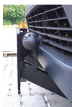
Piastra di montaggio conforme alla norma VSS, misura C, in versione fissa su un Toyota Hilux 4×4
