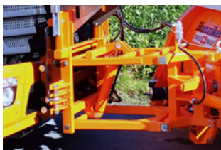
Piastra di montaggio conforme alla norma VSS, misura A, per autocarro Mercedes ATEGO 1530 4×2
