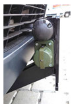
Piastra di montaggio conforme alla norma VSS, misura C, in versione fissa su un Toyota Hilux 4×4
