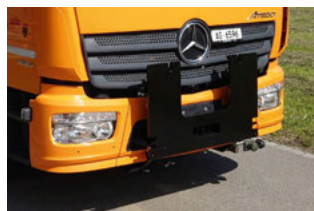
Piastra di montaggio conforme alla norma VSS, misura A, per autocarro Mercedes ATEGO 1530 4×2
