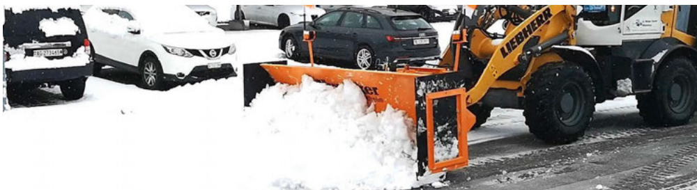
H2SH-280 SF: Barriere di espulsione abbassate per aumentare il volume di neve trasportato nell'area
