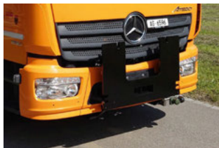
Normanbauplatte VSS Gr. A an LKW Mercedes ATEGO 1530 4 × 2
