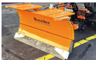
H1-160 SF: Seitenflügel hochgestellt (Einseitenräumung) und abgesenkt (Arealräumung)
