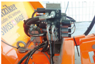
Elektrohydraulische Steuerungen proportional oder schwarz/ weiss je nach Kundenbedürfnis
