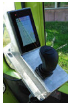
Elektrohydraulische Steuerungen proportional oder schwarz/ weiss je nach Kundenbedürfnis
