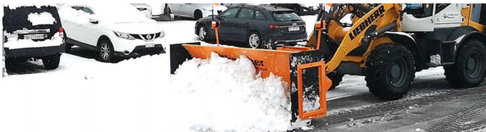
H2SH-280 SF: Seitenflügel abgesenkt für grösseres Schneemitnahmevermögen im Arealräumeinsatz
