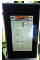
Elektrohydraulische Steuerungen proportional oder schwarz/ weiss je nach Kundenbedürfnis
