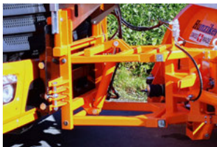
Normanbauplatte VSS Gr. A an LKW Mercedes ATEGO 1530 4 × 2
