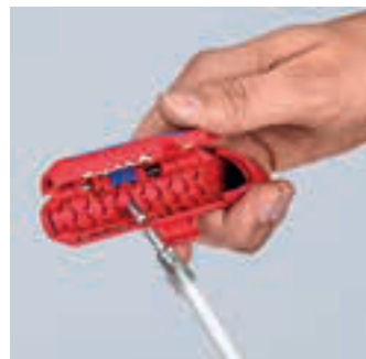
Abisolieren eines Koaxialkabels
