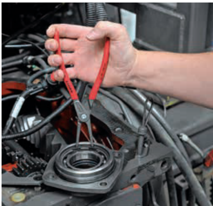
Stabile, eingesetzte Spitzen aus hochverdichtetem Federstahl
