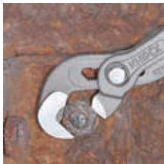
Arbeiten an verrosteter Mutter mit verrundeten Kanten
