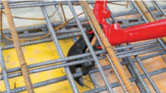
Die besondere Kopfform des Mattenschneiders ermöglicht das Schneiden flachliegender Baustähle
