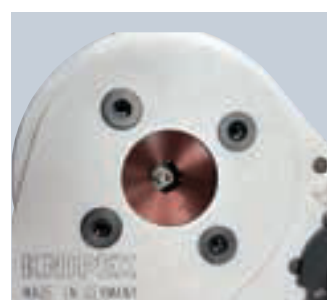
Synchrone Zustellung der vier Crimpdorne erzielt optimales Crimp-Ergebnis mit acht Eindrücken (4/8-Indent)
