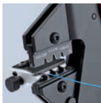
97 43 200 mit Crimpeinsatz 97 49 24 und Kontaktaufnahme 97 49 93 für D-Sub-Stecker
