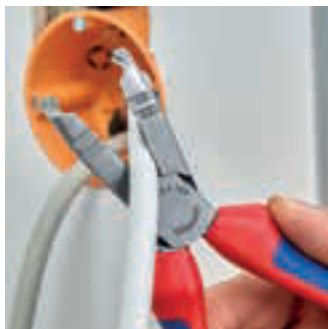
Schneiden von Kabeln bis Ø 13 mm
