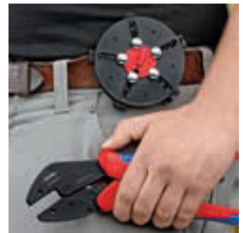
Magazin für Crimpeinsätze kann am Gürtel getragen werden
