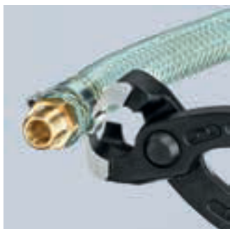
Abdichten Pneumatikschlauch an Schnellkupplung
