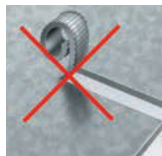
Ausklinken ohne Spanbrecher
