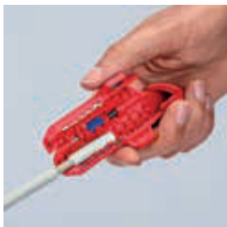
Abmanteln eines NYM-Kabels
