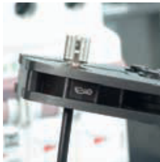
Gut sichtbare Kennzeichnung der Crimpeinsätze mit Piktogrammen
