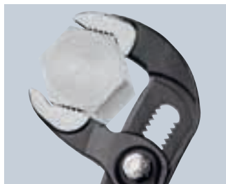
Gegen die Drehrichtung versetzte Zähne bewirken einen Selbstklemmeffekt und verhindern das Abrutschen am Werkstück.
