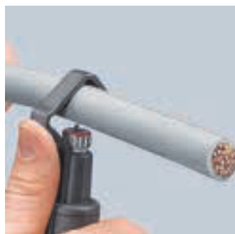
Ansetzen des Werkzeugs für Umfangsschnitt
