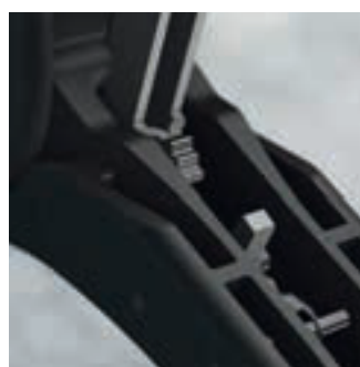
Die Zwangssperre stellt beim Crimpen immer den perfekten Anpressdruck sicher
