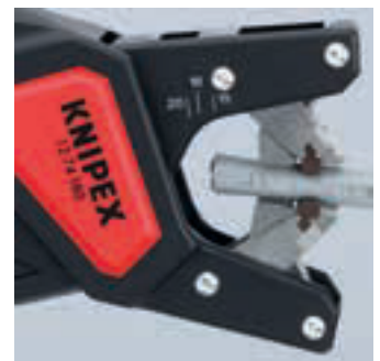
Einfaches Ablesen der gewünschten Abisolierlänge
