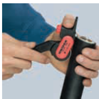
Ansetzen des Werkzeugs für Längsschnitt
