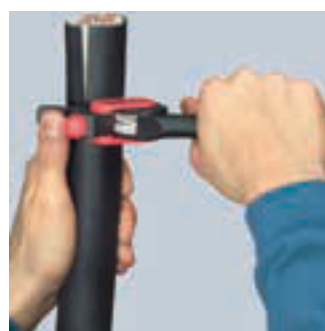
Drehen des Werkzeugs für Umfangsschnitt
