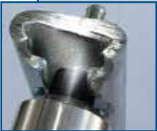
Beispiel für eine verlängerte vordere Hülse mit Sondermundstück.
