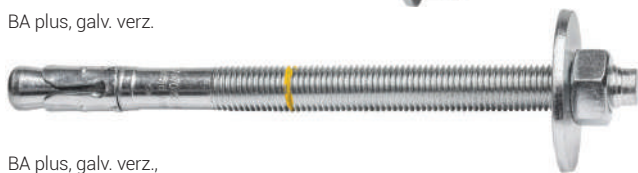
BA plus, galv. verz., mit großer Scheibe nach ISO 7094 (DIN 440) für den Holzbau
