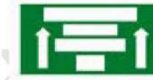
(Π-84) Γέφυρα σήμανσης με αναγραφή κατευθύνσεων προ ανισόπεδου κόμβου με αφαίρεση λωρίδας του αυτοκινητόδρομου.
